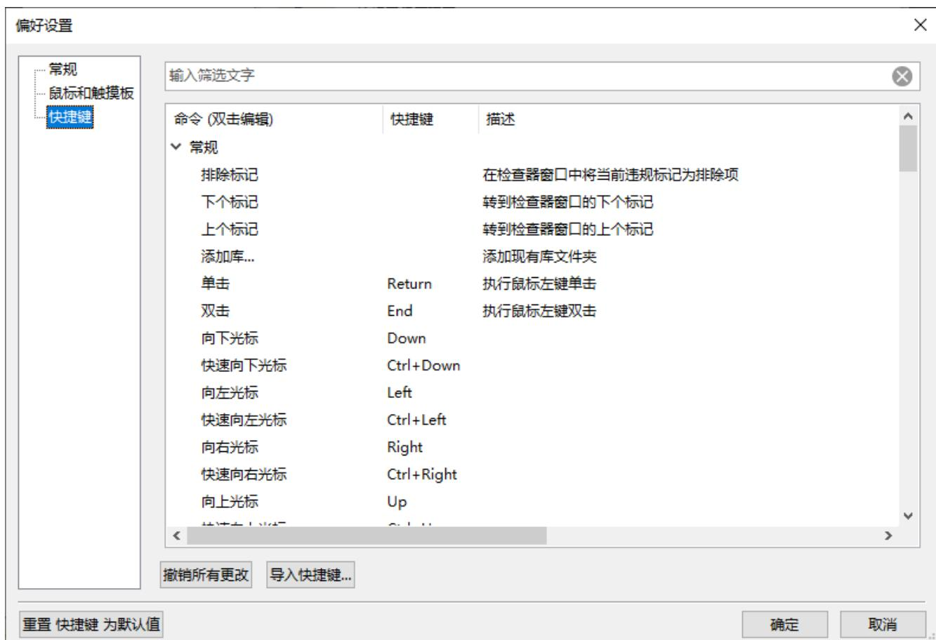
可以使用此对话框自定义用于控制 KiCad 的快捷键。公用部分中的快捷键在每个 KiCad 程序之间共享。当程序运行时，会显示每个特定 KiCad 程序的快捷键。您可以将相同的快捷键分配给不同 KiCad 程序（例如原理图编辑器和电路板编辑器）中的不同操作，但不能将一个快捷键分配给同一程序中的多个操作。
