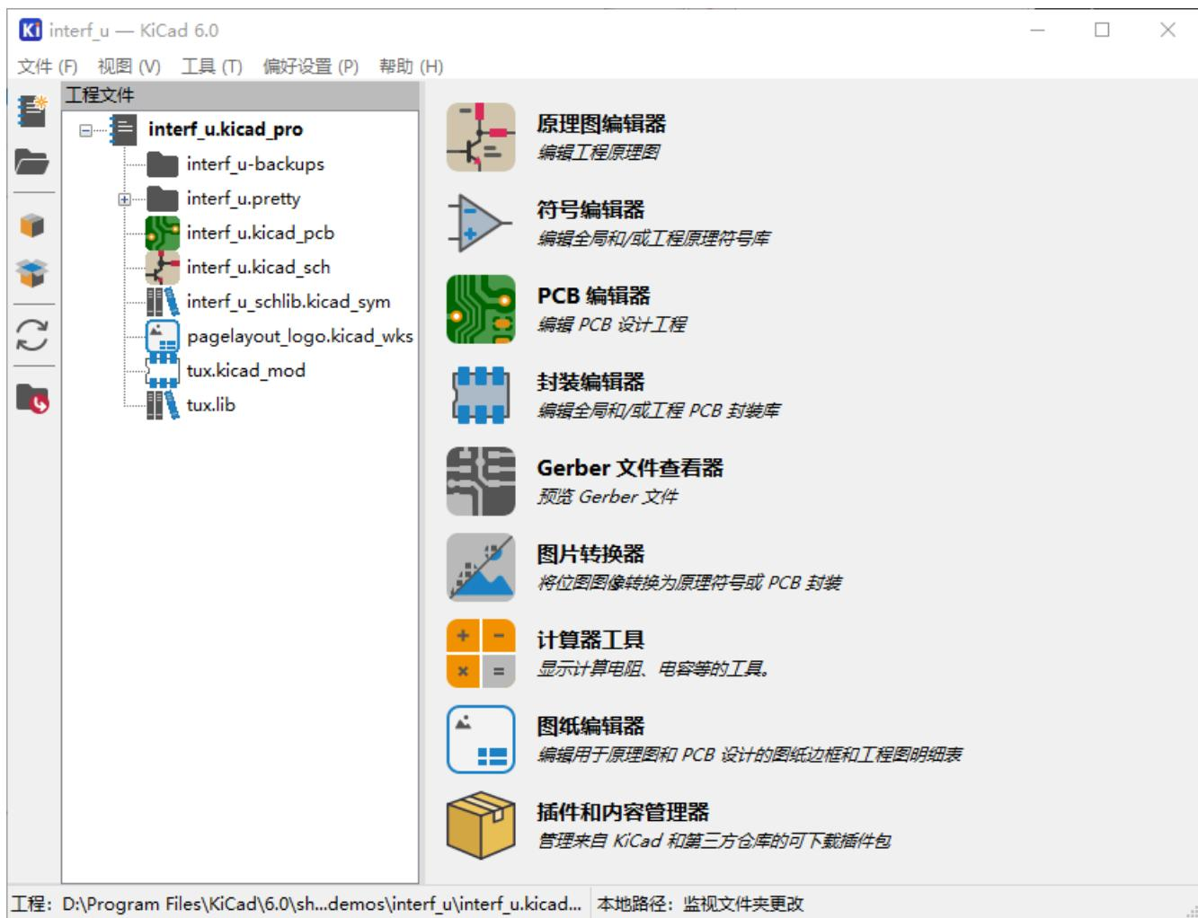
KiCad 工程管理器窗口由左侧的树状视图和右侧的启动器组成，前者显示与打开的工程相关的文件，后者则包含各种编辑器和工具的快捷方式。
